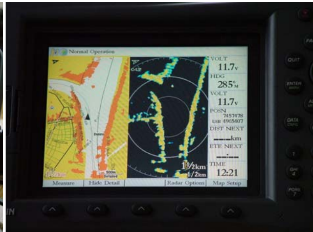
Preklapanje radarske slike preko karte sa i bez senzora kursa. Kod stajanja u mestu moguća su odstupanja u preklopu kada se ne koristi el.kompas (desno), Na desnoj slici se jasno vide privezane barže uz obalu u desnom donjem uglu.
